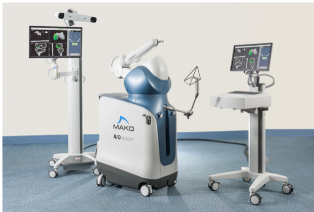
Figura 1. Sistema Mako. Sensores, pantalla, brazo robótico y módulo guía (computador para interacción).
