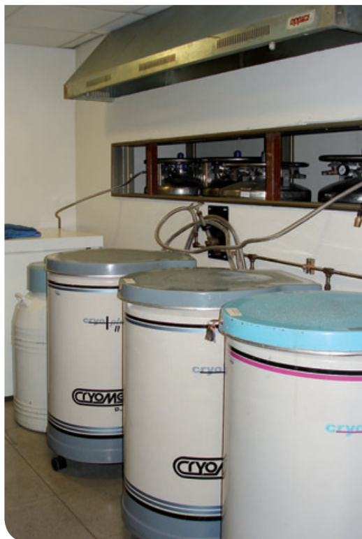
Figura 1. Criopreservación de células madres hematopoyéticas a -196^{\circ}\text{C} en Nitrógeno líquido.
